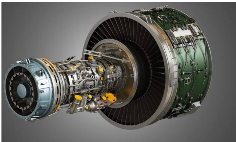
Рис 1. Модель двигуна Pratt & Whitney GTF у 3D-рендері
