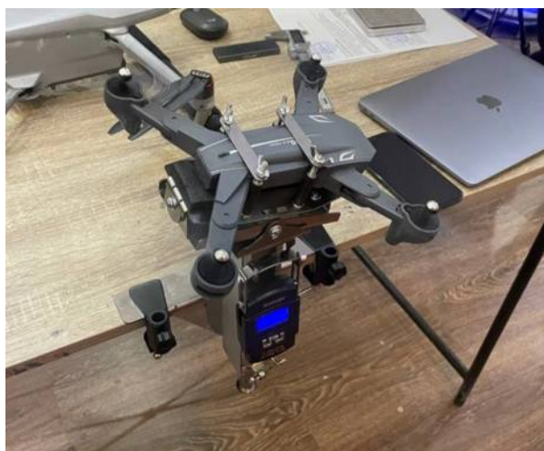
Рис.1. Стенд для випробування малих квадрокоптерів
