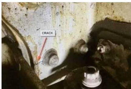
Рис.2. Виявлена тріщина у елементі вузла кріплення крила до фюзеляжу
