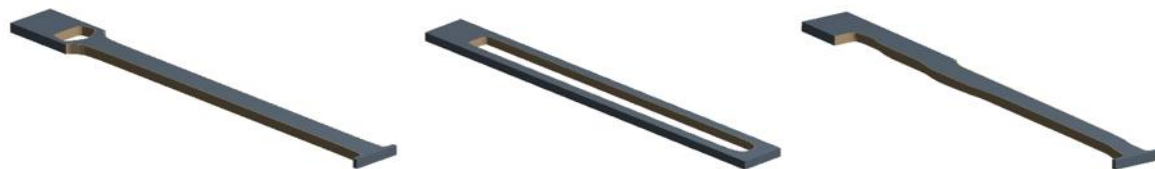
Рис.1. Варіанти оптимізованої форми пластини для різних випадків навантаження
