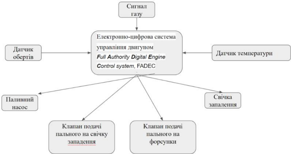
Рис. 3. Схема електронно-цифрової системи управління двигуном
