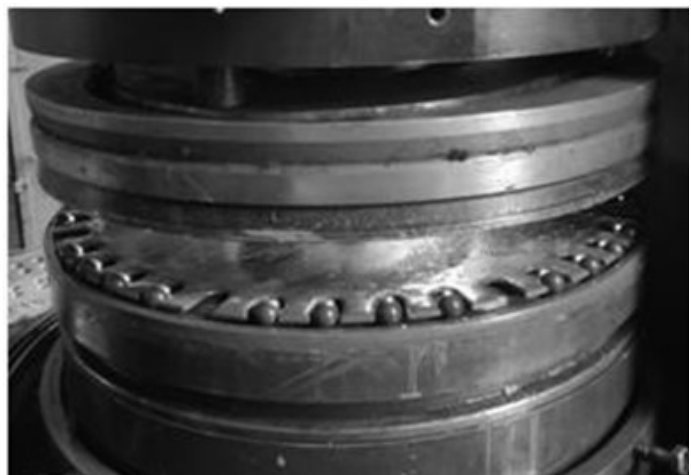
Рис. 2 – Розташування керамічних куль у сепараторі з відкритими пазами
