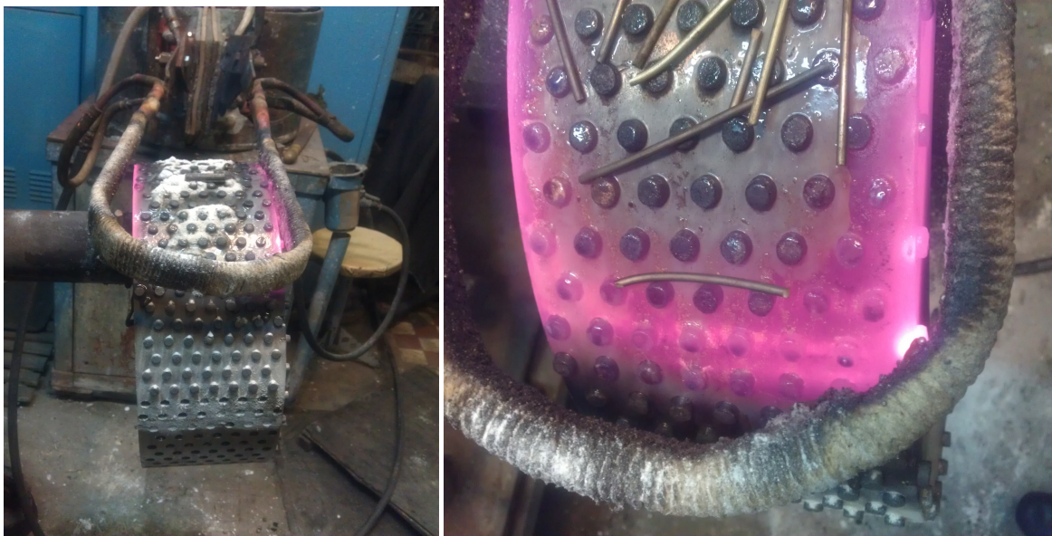
Рис. 3 – Зображення барабану шліфувального на операції ручного запаювання алмазовмісних твердосплавних вставок з підігрівом на установці ТВЧ
