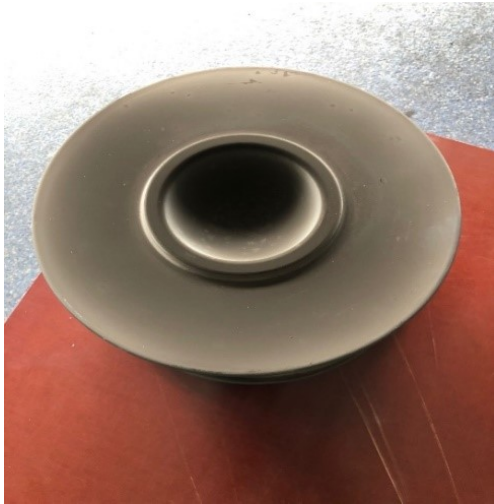
Рис. 2 – Штамповий інструмент – матриці для гарячого пресування: до азотування ( a ) та азотована ( б )
