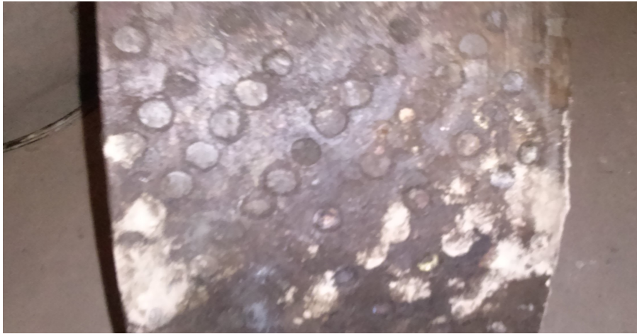
Рис. 4 – Фрагмент дефектної частини шліфувального барабана
