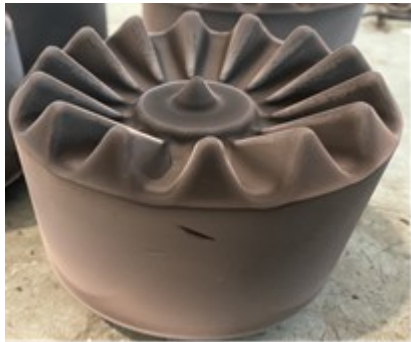
Рис. 3 – Зміцнений зубчастий пуансон для оброблення заготовок деталей
