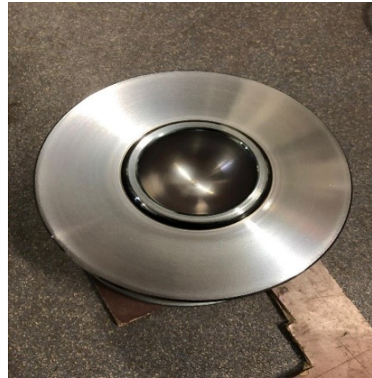
Рис. 2 – Штамповий інструмент – матриці для гарячого пресування: до азотування ( a ) та азотована ( б )
