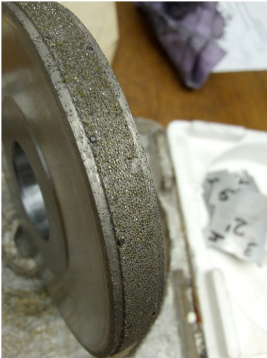
Рис. 1 – Робоча поверхня алмазного правлячого ролика в плані: середня частина з протекцією CVD-алмазами і дві зовнішні занижені як базові. Зерна порошку AC200T 400/315 розподілено рівномірно
