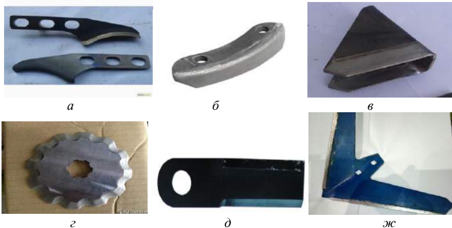
Рис. 3. Приклади робочих органів сільськогосподарських машин із композиційними покриттями (а - ж)
