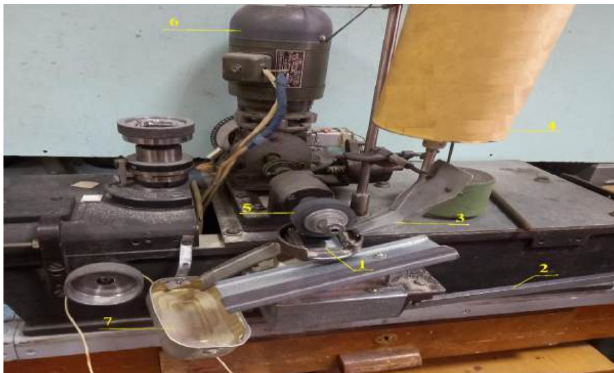
Рис. 3. Установки для випробування на абразивну стійкість 1 – зразок, 2 – важіль, 3 – направляючий лоток для абразиву, 4 – дозуючий пристрій подачі абразивних часток, 5 – гумовий ролик, 6 – привід обертання, 7 – бункер для відходів абразиву.
