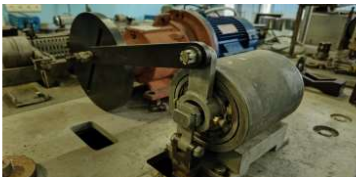
Рис. 1.– Фотографія розробленої установки для лабораторних ресурсних випробувань авіаційних шарнірних підшипників ковзання.
