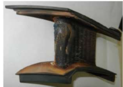
Рис.2. Прогари соплової лопатки
