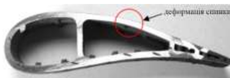
Рис.1. Деформація спинки соплової лопатки
