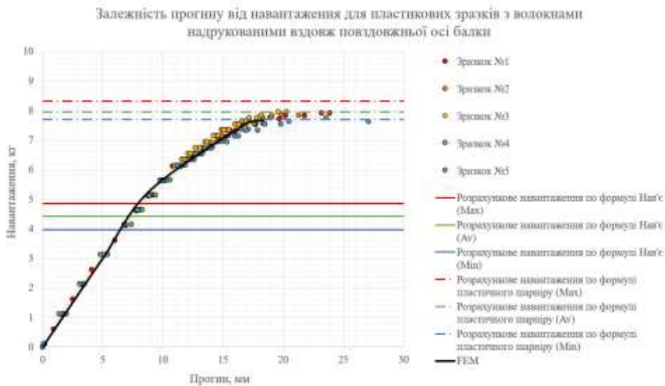
Рис.1. Графік залежності прогину від навантаження для зразків з волокнами, надрукованими вздовж повздожньої осі балки
