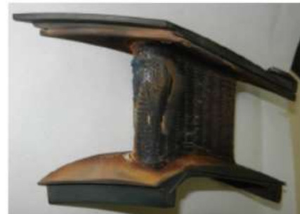
Рис.2. Прогари соплової лопатки
