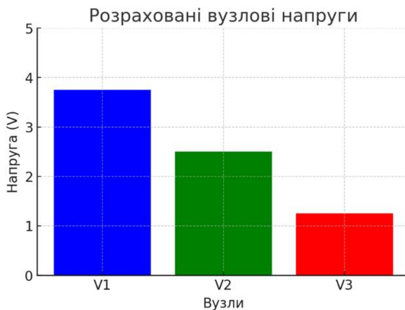
Рис. 1. Графік, що ілюструє розподіл напруг у вузлах електричної системи після розв'язання вузлового рівняння методом Гауса
