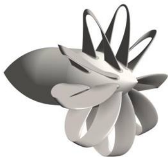
Рис.1.Тандемний вентилятор з об'єднуючою тороїдально - спіральною закінцівкою лопатей
