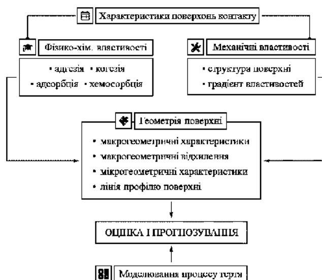
Рис. 1. Схема визначення цільових показників зношування вузлів на базі характеристик поверхонь та моделювання процесу тертя
