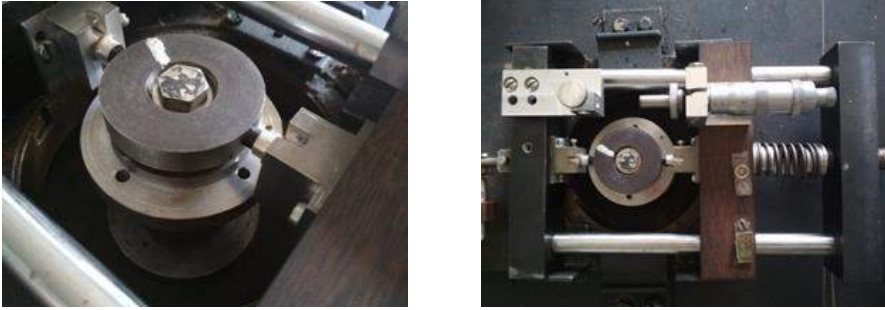
Рис. 4. Каркасний механізм кріплення зразків для досліджень.
