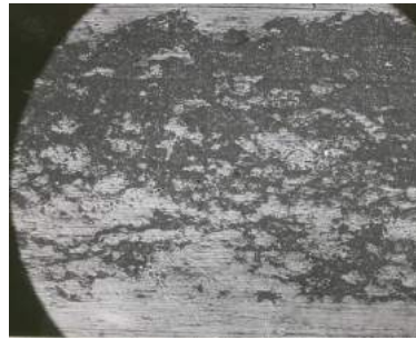
Рис. 2. Поверхня електролітичного хрому на ВТ-22 після тертя по детонаційному покриттю WC–NiP \times 350
