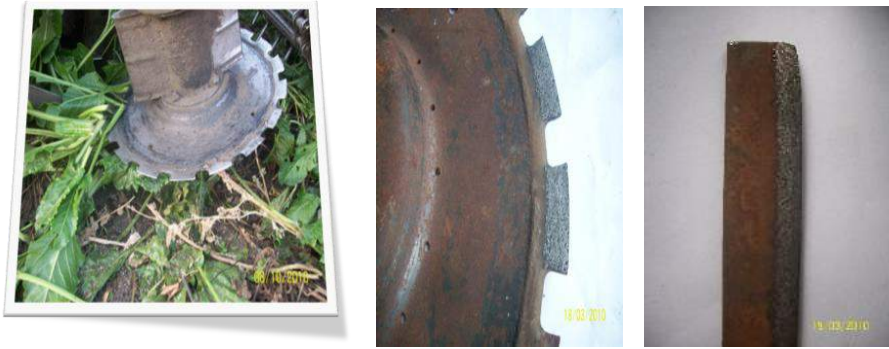
Рис. 7. Приклади відновлених і зміцнених деталей робочих органів сільськогосподарських машин методом ЕІЛ: а) культиваторна лапа; б), в) – ножі подрібнюючого барабану кукурудозбирального комбайна; г), д) – ножі бурякозбиральних машин, ж – ніж копача;
